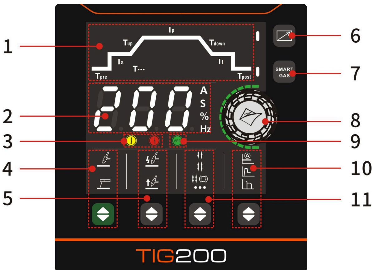
Abbildung 6-1 HD-Digitaldisplay
